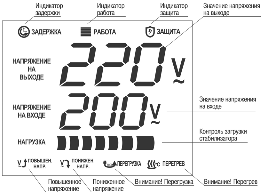
Рис 2. Индикация режимов работы настенных стабилизаторов
