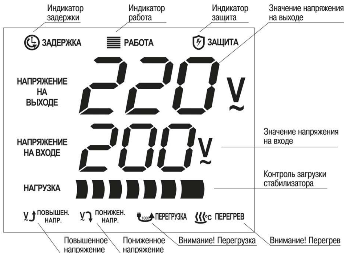
Рис 6. Индикация режимов работы стабилизаторов
