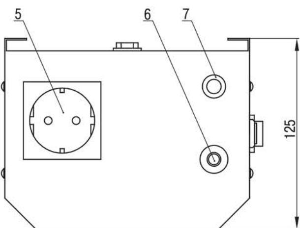
Рис 4. Верхняя панель стабилизатора
