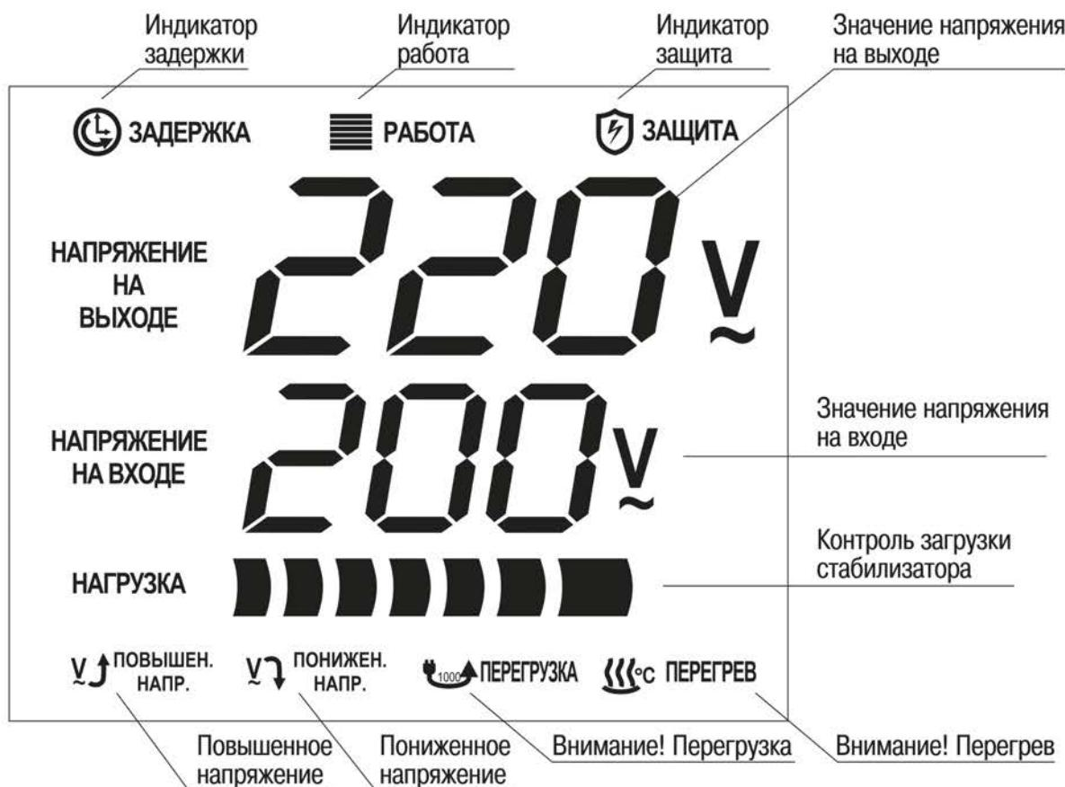
Рис 6. Индикация режимов работы стабилизаторов
