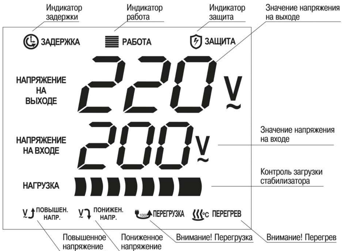
Рис 2. Индикация режимов работы стабилизаторов
