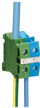
Преобразование схемы TN-C в TN-S Разделение PEN-проводника сечением 10 мм 2 0 371 98 + 0 371 04 + 0 375 42
