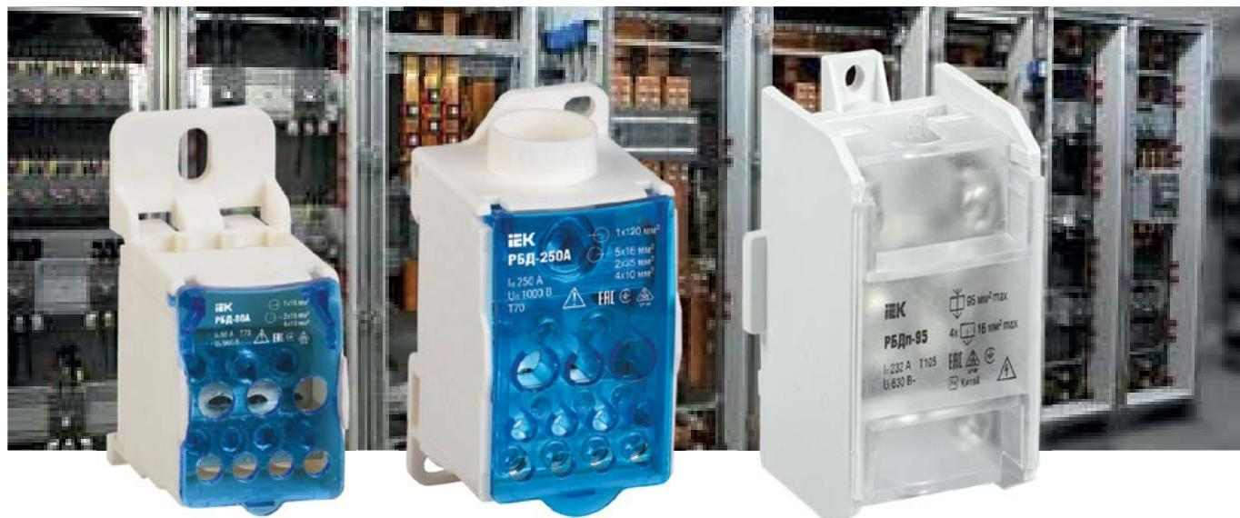
**Серия РБД IEK®** используется в качестве клеммного зажима при подключении к проводнику большого сечения нескольких проводников меньшего сечения, для создания упорядоченных систем распределения в шкафах, для организации главной заземляющей шины.
