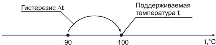
При этом охладительный элемент, управляемый терморегулятором, будет охлаждать объект до +90 °С и отключаться. После повышения температуры на 10°С, т.е. до 100 °С, терморегулятор снова включит охладительный элемент, начнется охлаждение и цикл повторится.
