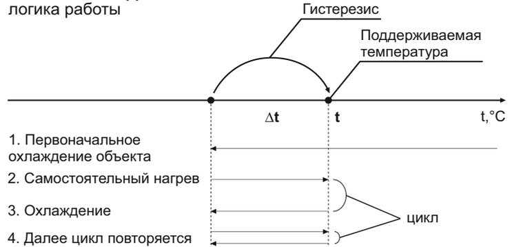
Гистерезис - это разница между температурой включения и отключения нагрузки терморегулятора (падение температуры).
