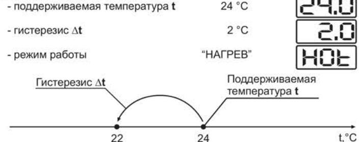
При этом нагреватель, управляемый терморегулятором, будет нагревать помещение до 24 °C и отключаться. После остывания помещения на 2°C (до 22 °C), терморегулятор снова включит нагреватель и цикл повторится.
