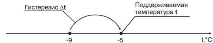
При этом охладительный элемент, управляемый терморегулятором, будет охлаждать морозильную камеру до -9 °C и отключаться. После повышения в ней температуры на 4°C, т.е. до -5 °C, терморегулятор снова включит охладительный элемент, начнется охлаждение и цикл повторится.
