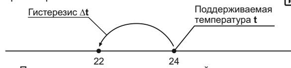
При этом нагреватель, управляемый терморегулятором, будет нагревать помещение до 24 °С и отключаться. После остывания помещения на 2°C (до 22 °С), терморегулятор снова включит нагреватель и цикл повторится.
