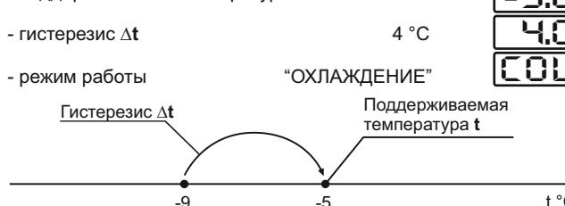
При этом охладительный элемент, управляемый терморегулятором, будет охлаждать морозильную камеру до -5 °С и отключаться. После повышения в ней температуры на 4°C, т.е. до -5 °С, терморегулятор снова включит охладительный элемент, начнется охлаждение и цикл повторится.
