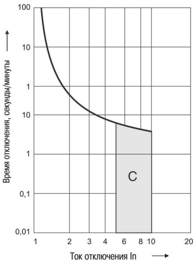
а) время-токовая характеристика автоматического выключателя ВА47-60М тип С
