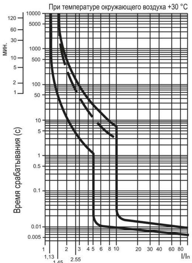
б) время-токовая характеристика автоматического выключателя ВА47-29 тип С
