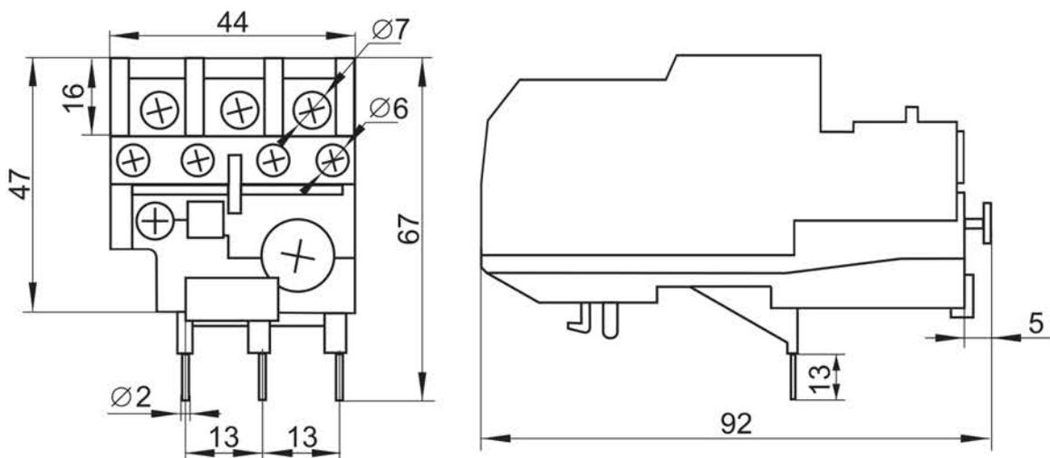
Рисунок 2. Габаритные и установочные размеры реле РТИ-1301... РТИ-1322.
