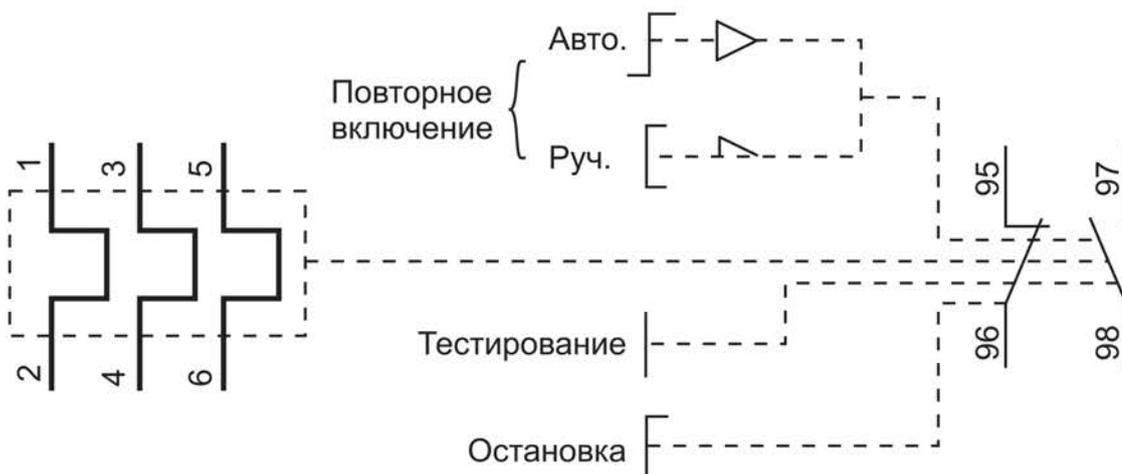
Рисунок 5. Схема электрическая принципиальная реле.
