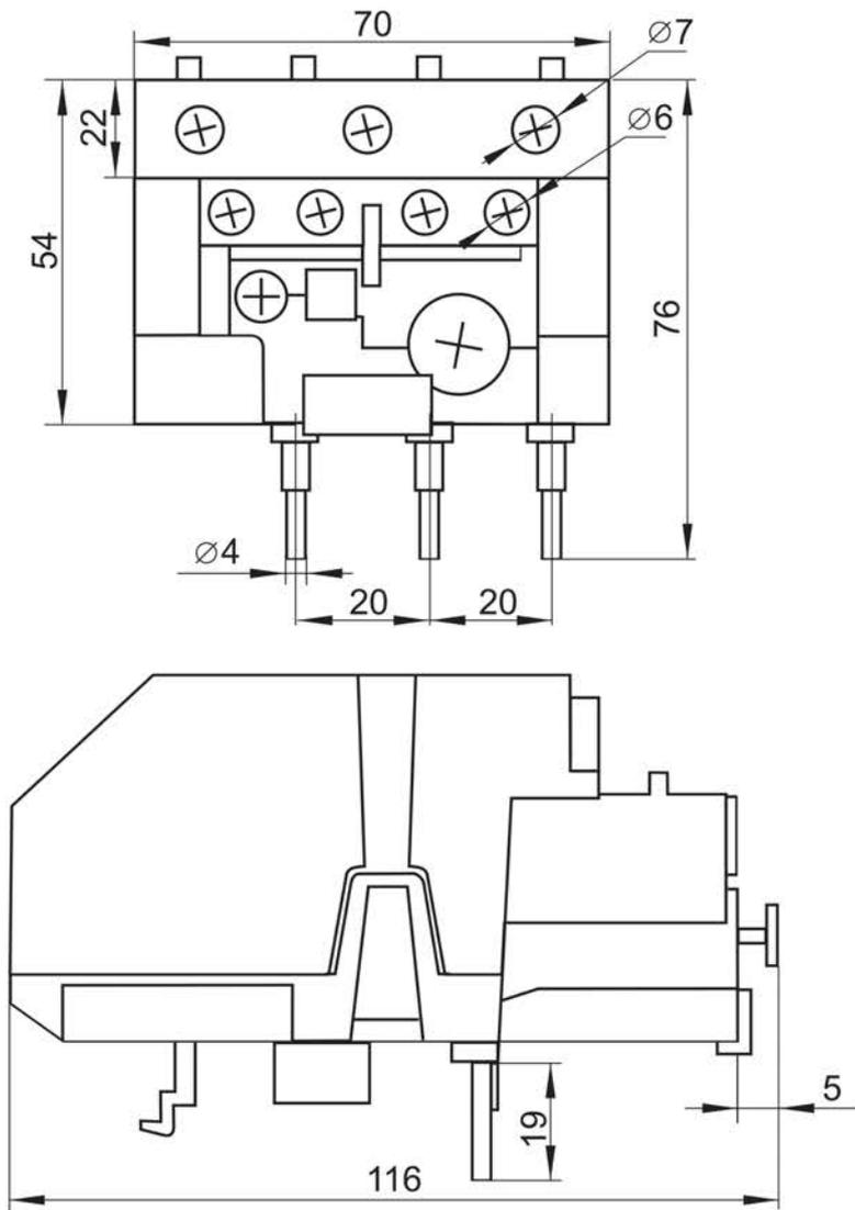
Рисунок 4. Габаритные и установочные размеры реле РТИ-3353...РТИ-3365.
