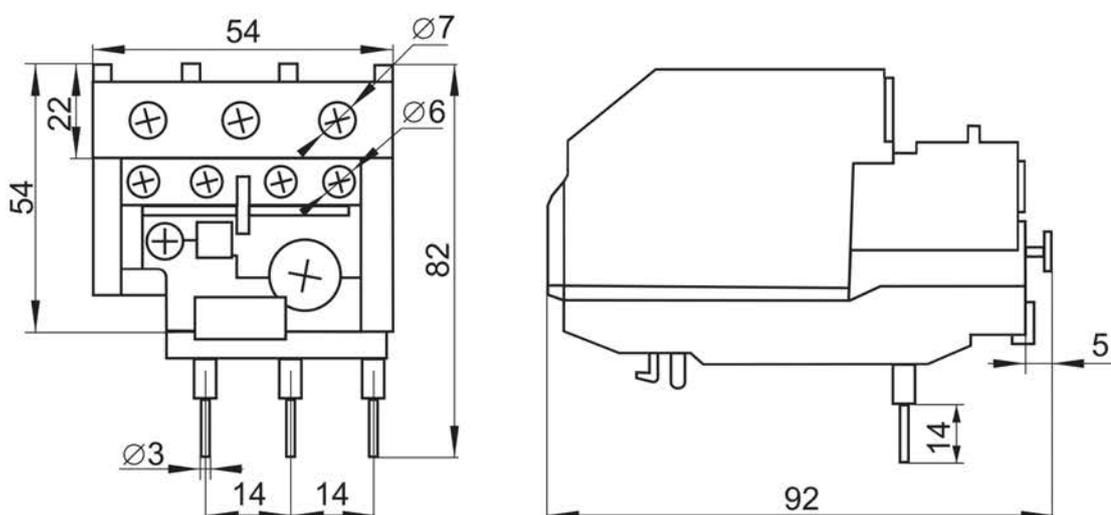
Рисунок 3. Габаритные и установочные размеры реле РТИ-2355.
