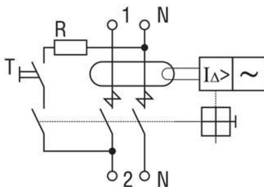
Рисунок 3 – Схема электрическая принципиальная двухполюсных ВД
