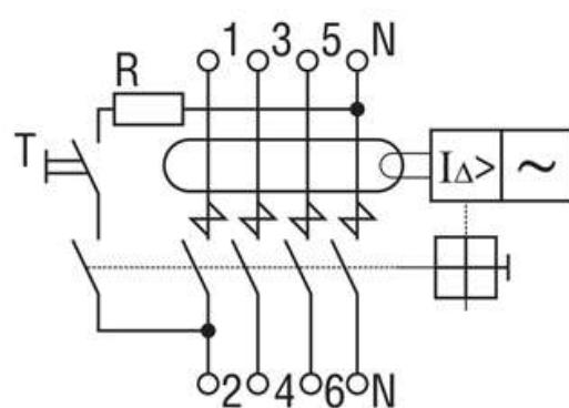
Рисунок 4 – Схема электрическая принципиальная четырехполюсных ВД
