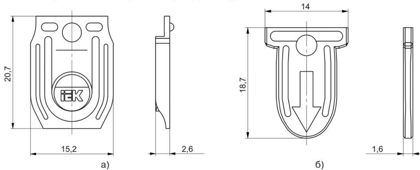
Рисунок 1: а) – пломба; б) – ключ
