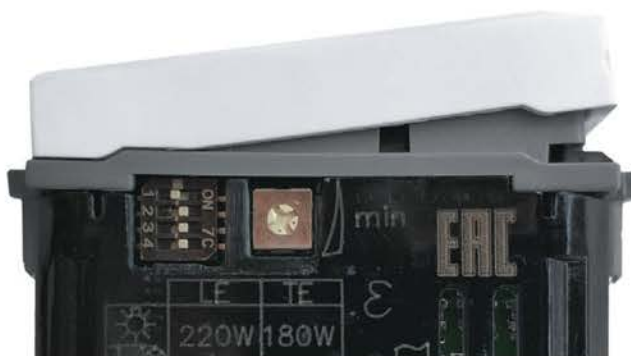
Рис. 3. Переключатель Sw1 - в положении OFF, остальные - в положении ON
