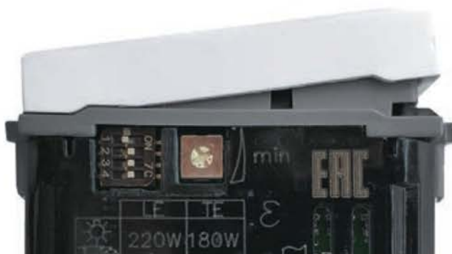
Рис. 3. Переключатель Sw1 - в положении OFF, остальные - в положении ON
