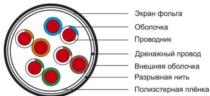
Рисунок 4 – Конструкция кабеля типа F/UTP (количество жил 4×2)
