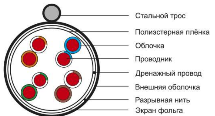
Рисунок 8 – Конструкция кабеля типа F/UTP (со стальным тросом)
