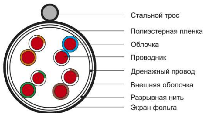
Рисунок 8 – Конструкция кабеля типа F/UTP (со стальным тросом)
