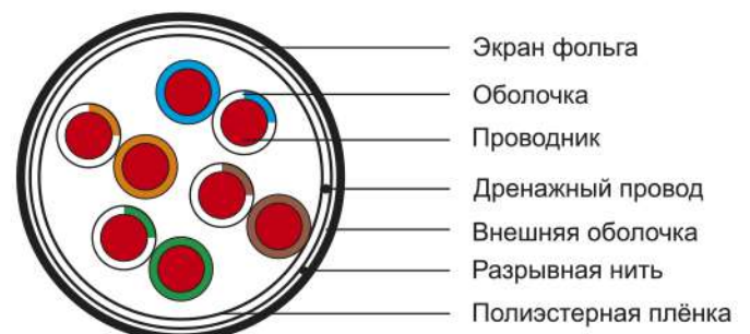
Рисунок 4 – Конструкция кабеля типа F/UTP (количество жил 4×2)
