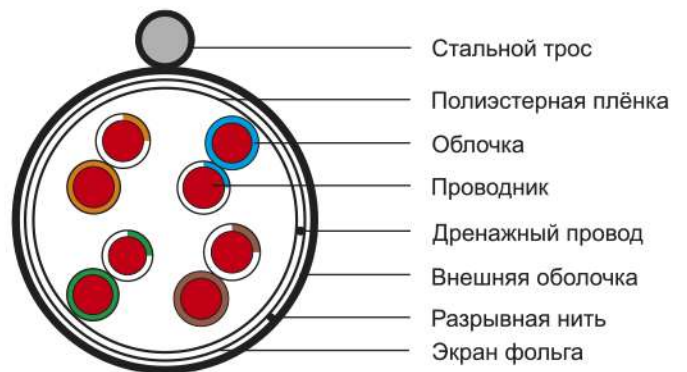
Рисунок 8 – Конструкция кабеля типа F/UTP (со стальным тросом)
