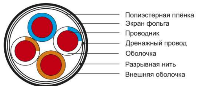
Рисунок 2 – Конструкция кабеля типа F/UTP (количество жил 2×2)
