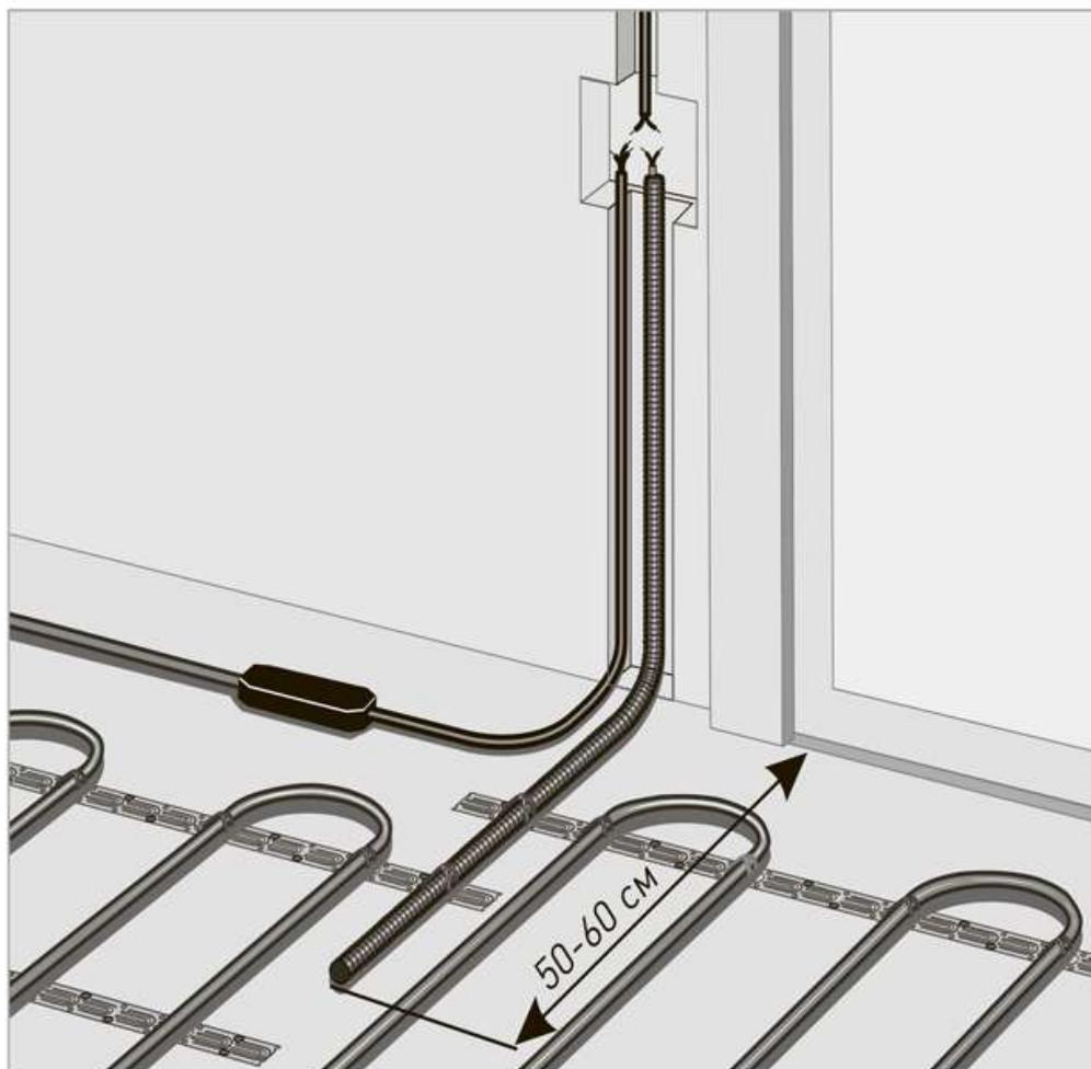
Рисунок 3 – Монтаж датчика температуры пола
