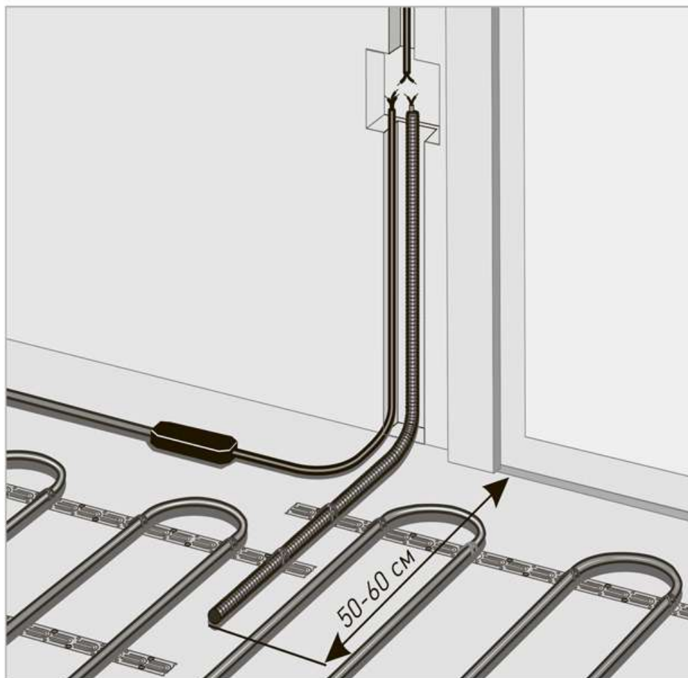
Рисунок 3 – Монтаж датчика температуры пола
