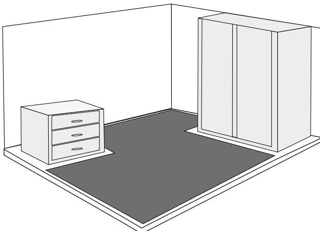
3) Под полученную полезную площадь подберите нагревательный мат, площадь которого примерно равна или меньше площади обогрева.
