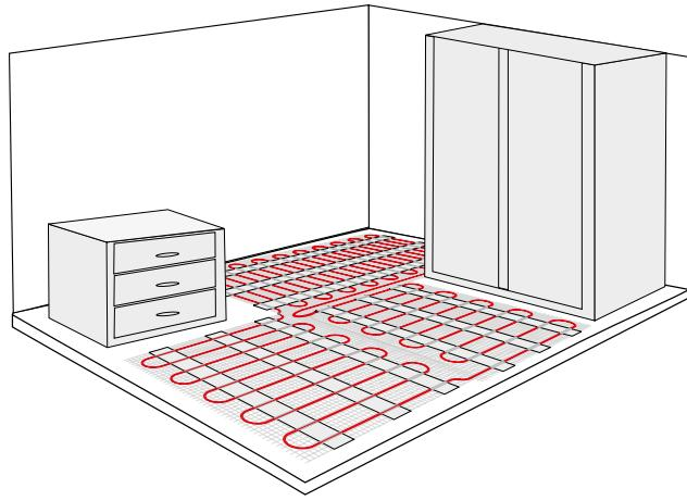
4) Чтобы разложить мат по форме обогреваемой площади, необходимо разрезать его на фрагменты, при этом не затрагивая нагревательный кабель. Не допускается наложение фрагментов друг на друга.
