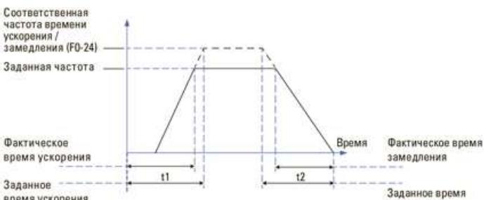
Преобразователь частоты серии VECTOR-100 поддерживает 4 группы времени ускорения/замедления, которые могут быть выбраны с помощью многофункциональных цифровых входных терминалов.
