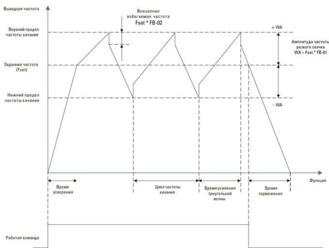
Схема работы частоты качания
