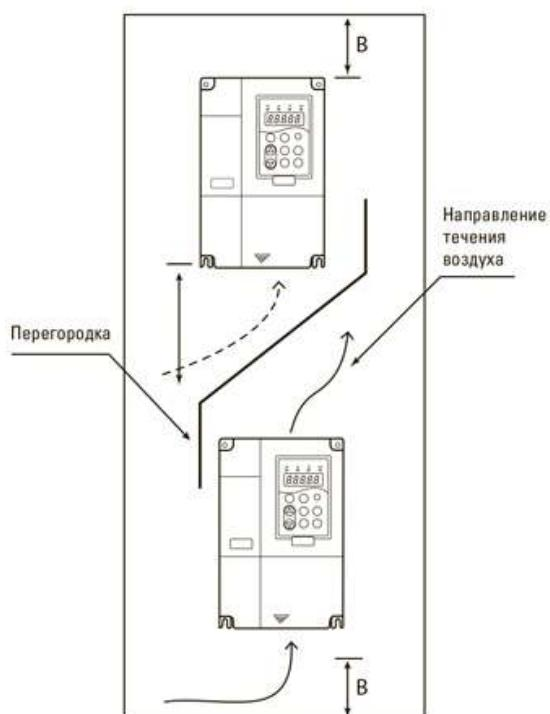
Монтаж одиночного устройства: при мощности не более 22 кВт производить без учета размера А. При мощности более 22 кВт, размер А должен превышать 50 мм.
