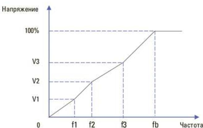
**Внимание:** Многоточечная кривая V/F устанавливается на основе характеристик нагрузки двигателя. Соотношение между напряжениями и частотами составляют:  $V1 \leq V2 \leq V3 \leq V4$ ,  $F1 \leq F2 \leq F3 \leq F4$ . На низкой частоте при более высоком напряжении это может вызвать перегрев или даже возгорание двигателя, и требуется ограничение сверхтоков или защита от сверхтоков привода переменного тока.
