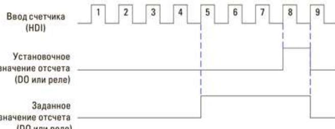
Схема функции отсчёта
