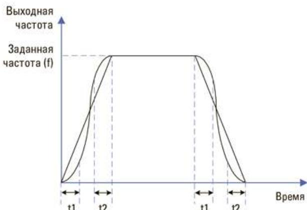
**Картина А:** схема S-кривой ускорения/торможения А
