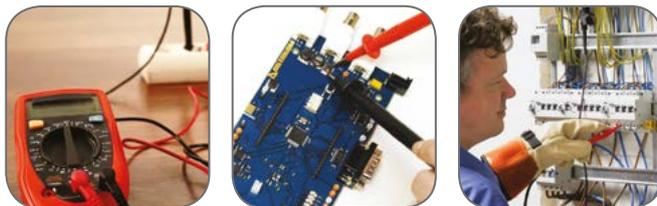
Широко используются в электротехнике и электронике для определения ключевых характеристик цепи постоянного и переменного тока. В зависимости от своей функциональной оснащённости, приборы могут выполнять измерение базовых параметров: силы тока, напряжения, сопротивления цепи, а также определять полярность.
