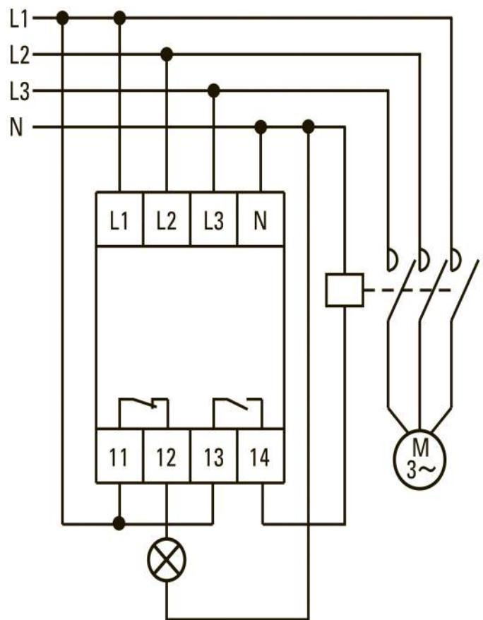
Рис. 5 Схема подключения реле
