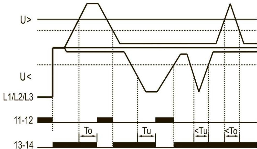
Рис. 2 Работа реле при повышенном и пониженном напряжении
