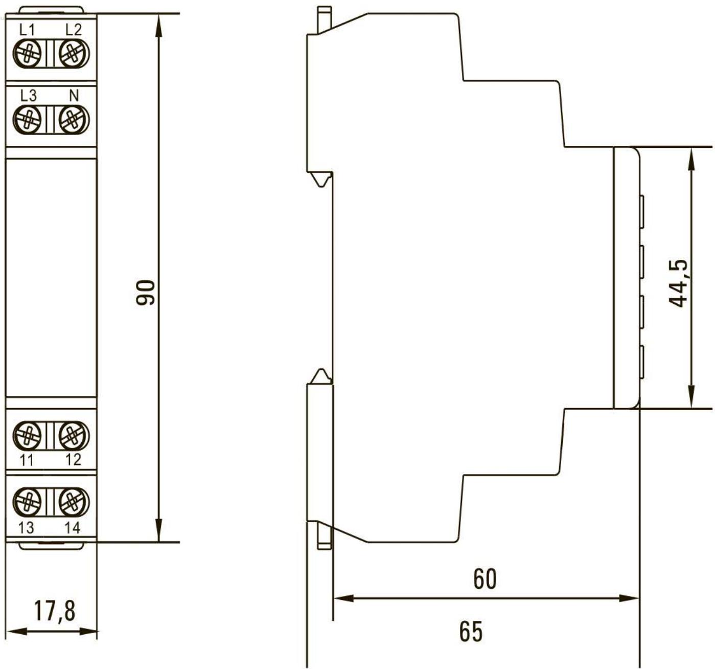
Рис. 6 Габаритные размеры реле контроля фаз
