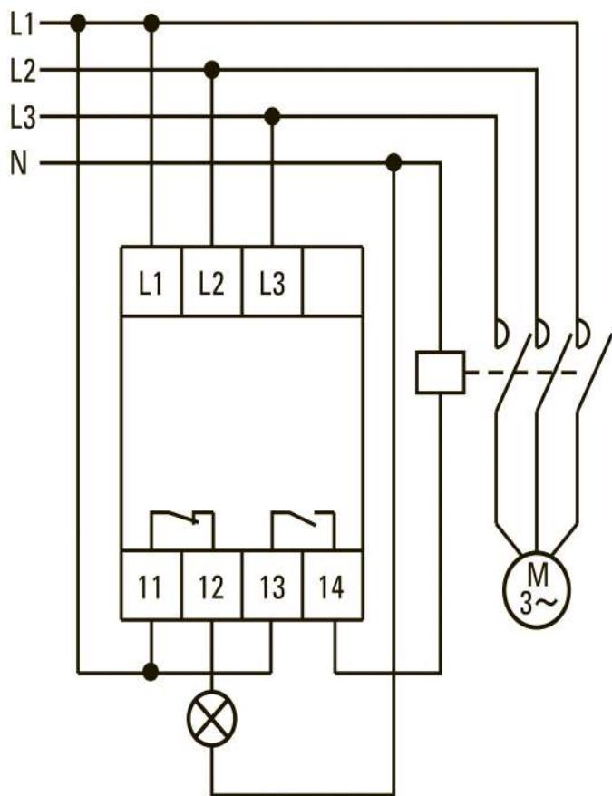
4-х проводная схема
