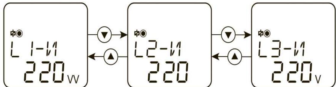
Рис. 6 Отображение трехфазного напряжения
