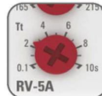
Возможность регулировки времени задержки срабатывания
