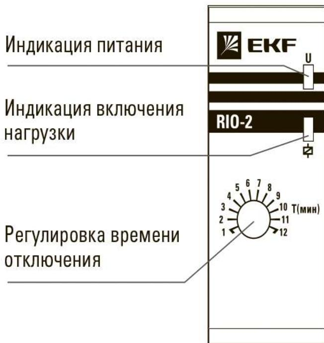
Выключение реле осуществляется нажатием кнопки или по истечении времени работы встроенного таймера. Двукратное нажатие кнопки в течение 1 сек. Включает реле в непрерывный режим, до момента подачи следующего импульса (нажатия кнопки).
