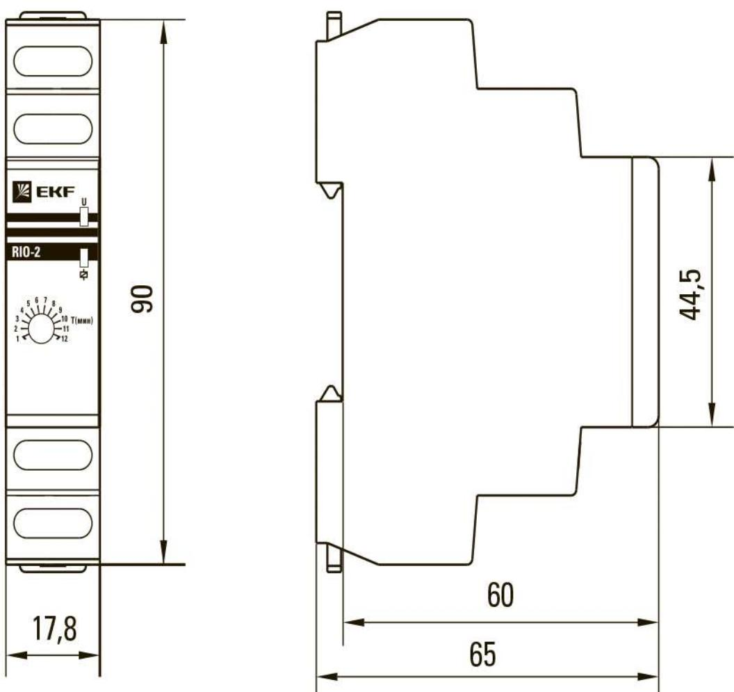
Рис. 5 Габаритные и установочные размеры
