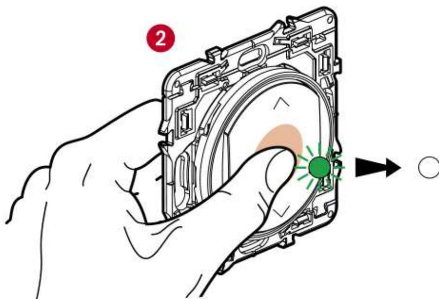
Нажмите кнопку для активирования беспроводной связи, светодиодный индикатор начинает мигать зеленым светом и затем гаснет.
