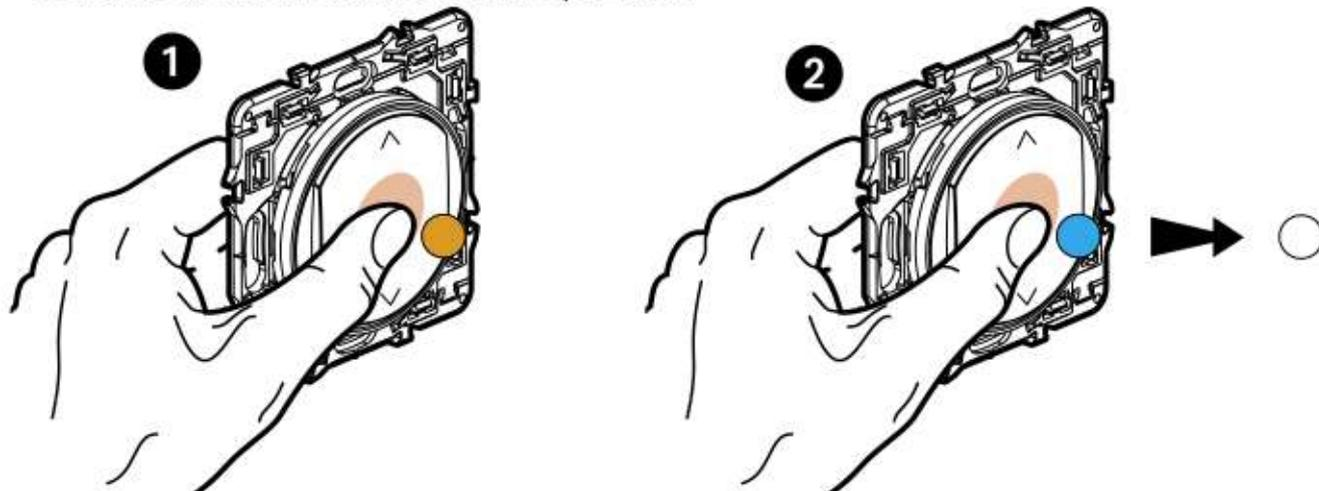
Беспроводной выключатель можно связать с другим устройством, выполнив операции из раздела ⑤.
