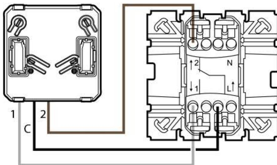
Режим кнопочного устройства
