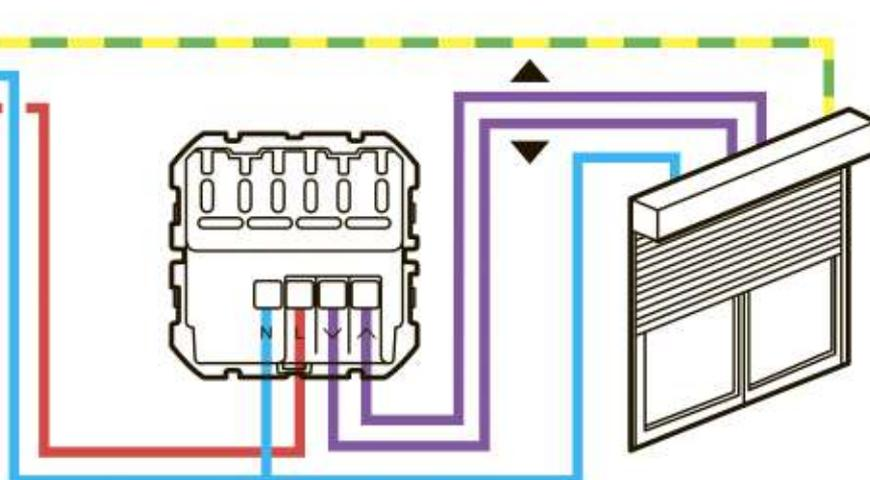
Решение Valena Life with Netatmo совместимо с рольставнями с механическим или электронным остановом, управляемым с помощью стандартного выключателя.
