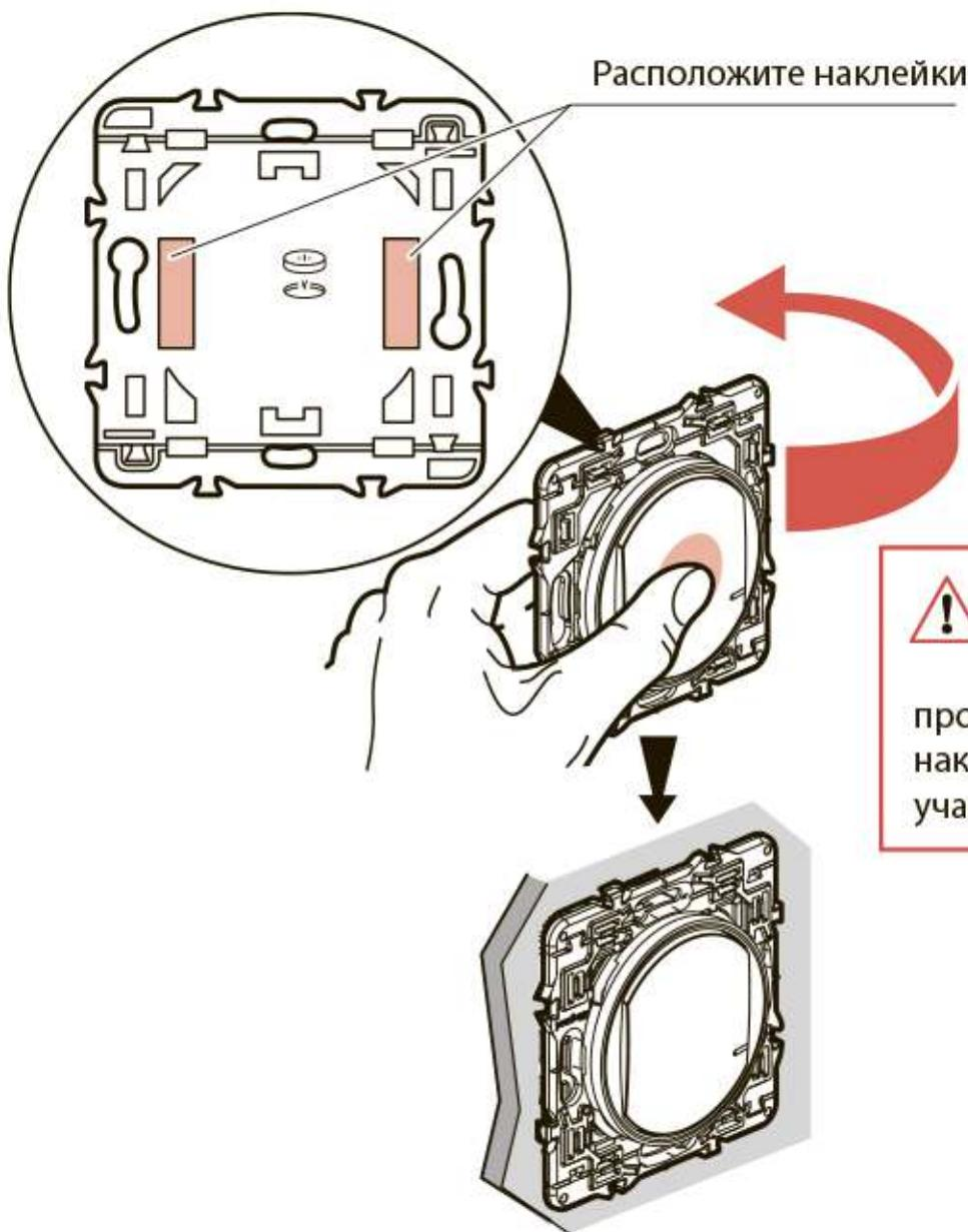
Беспроводные выключатели также можно прикрепить к стене или монтажной коробке винтами.
