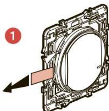
Возьмите умный беспроводной выключатель **из пакета**. Снимите защитную полоску с батареи питания выключателя.
