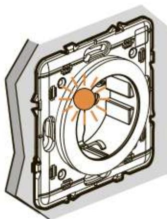
**4 Установите умный беспроводной выключатель из этого пакета**
