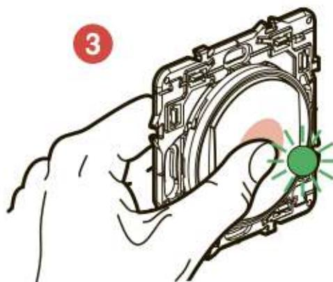
Кратковременно нажмите на каждый дополнительный беспроводной выключатель, чтобы активировать его. Индикатор замигает зеленым светом, затем будет ровно гореть оранжевым, а потом погаснет.
