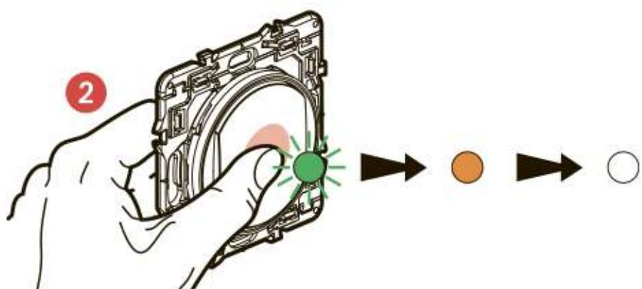
Активируйте умный беспроводной выключатель **кратковременным нажатием**. Индикатор замигает зеленым светом, затем будет ровно гореть оранжевым, а потом погаснет.
