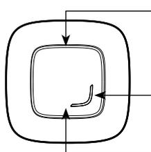
Выключение при кратковременном нажатии на верхнюю часть клавиши, уменьшение яркости при длительном нажатии.
