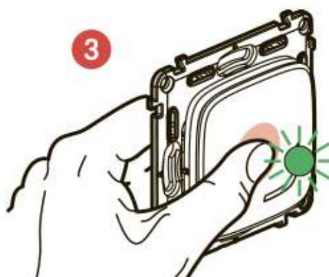
Кратковременно нажмите на каждый дополнительный беспроводной выключатель, чтобы активировать его. Индикатор замигает зеленым светом, затем начнет гореть ровно оранжевым светом и потом погаснет.
