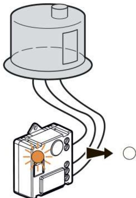
Индикатор **микромодуля** из этого пакета погаснет. **Схема управления с двух мест готова к работе.**
