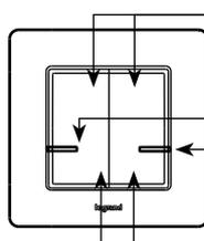
Выключение при кратковременном нажатии на верхнюю часть клавиши, уменьшение яркости при длительном нажатии.
