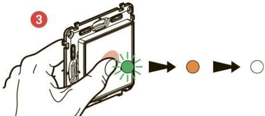
**Кратковременно нажмите** на каждый дополнительный беспроводной выключатель, чтобы активировать его. Индикатор замигает зеленым светом, затем начнет гореть ровно оранжевым светом и потом погаснет.
