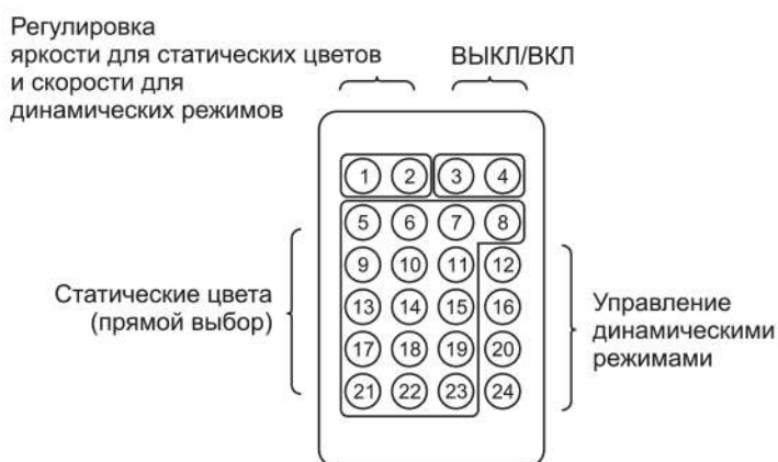
Рисунок 15 – Пульт дистанционного управления контроллера LSC2-RGB-072-IR-20-12-W
