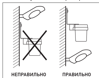
Схема установки фотореле
