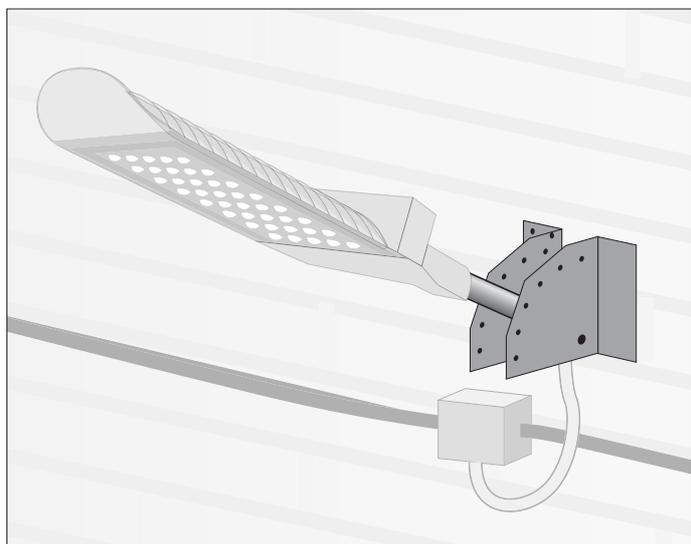
**Держатель для уличного светильника PSL на стену** с переменным углом наклона (0°, 15°, 30°, 45°, 60°, 75°) предназначен для крепления уличных светильников **типа РКУ/ЖКУ/ДКУ** к несущим поверхностям. Изготовлен из стального листа толщиной 1,5 мм. Диаметр посадочной трубы – 40, 45 и 60 мм.
