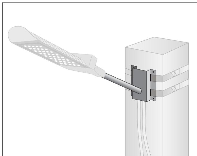
**Кронштейн под бандажную ленту PSL на столб** с углом наклона 15° предназначен для установки уличных светильников **типа РКУ/ЖКУ/ДКУ** на опоры, столбы с помощью бандажной (монтажной) ленты или на плоские поверхности с помощью саморезов, скоб. Изготовлен из стального листа толщиной 1,5 мм. Диаметр посадочной трубы – 40 и 60 мм.
