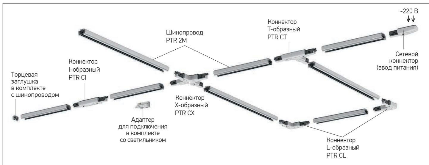
Шинопроводы используются для монтажа трековых светодиодных прожекторов **PTR jazzway**. Основой шинопровода является алюминиевый профиль, который крепится напрямую к потолку или подвешивается. С помощью коннекторов из шинопроводов можно собрать осветительную систему любой конфигурации.
