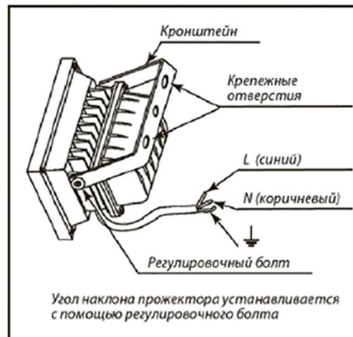
**Внимание!** Подключение должен осуществлять квалифицированный специалист. Отключите питание перед установкой. Использовать только при указанном напряжении сети. Обязательно обеспечьте герметичность клеммного соединения!
