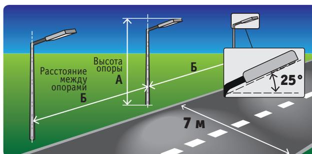
Для достижения равномерной освещенности дорог и улиц следуйте рекомендациям в таблице. При освещении дорог шириной до 7 м рекомендуется устанавливать светильники с одной стороны дороги, при ширине более 7 м – по обеим сторонам дороги.
