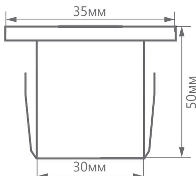
Светодиодный светильник **LN003** TM Feron предназначен для встройки в мебель. Служит дополнительным источником света в комнате, что актуально в тёмное время суток.
