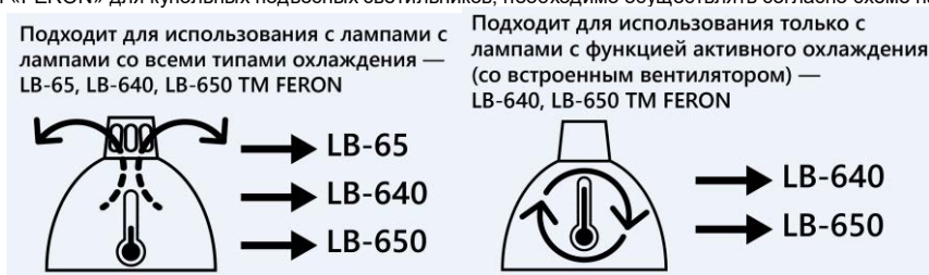
Рисунок 1 Слева – рекомендации по использованию моделей светодиодных ламп в светильниках с вентиляционными отверстиями в верхней части корпуса (со свободной конвекцией воздуха); справа - рекомендации по использованию моделей светодиодных ламп в светильниках без вентиляционных отверстий в верхней части корпуса (с затрудненной конвекцией воздуха).
