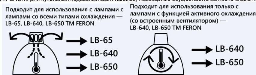
Рисунок 1 Слева – рекомендации по использованию моделей светодиодных ламп в светильниках с вентиляционными отверстиями в верхней части корпуса (со свободной конвекцией воздуха); справа - рекомендации по использованию моделей светодиодных ламп в светильниках без вентиляционных отверстий в верхней части корпуса (с затрудненной конвекцией воздуха).
