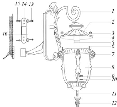
1 – рожок; 2 – верхняя крышка; 3 – декоративная гайка; 4 – ламподержатель; 5 – патрон; 6 – винты; 7 – каркас; 8 – стеклянный рассеиватель; 9 – гайка; 10 – гровер; 11 – полое винтовое крепление; 12 – балансина; 13 – саморезы; 14 – крепежная скоба; 15 – фиксаторы саморезов; 16 – шайба.
