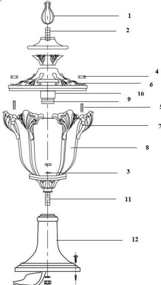
1 – балюсина; 2 – резьбовое крепление; 3 – гровер; 4 – гайка; 5 – винты; 6 – верхняя крышка; 7 – каркас; 8 – стеклянный рассеиватель; 9 – патрон; 10 – ламподержатель; 11 – резьбовое крепление; 12 – постамент.
