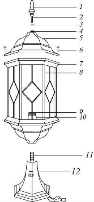
1 – балюсина; 2 – резьбовое крепление; 3 – гровер; 4 – гайка; 5 – верхняя крышка; 6 – винты; 7 – каркас; 8 – стеклянный рассеиватель; 9 – патрон; 10 – ламподержатель; 11 – резьбовое крепление; 12 – постамент; 13 – гайка декоративная.
