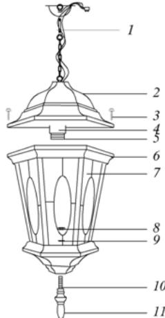
1 – цепь для подвеса; 2 – крышка; 3 – винты; 4 – ламподержатель; 5 – патрон для лампы; 6 – каркас; 7 – рассеиватель; 8 – гайка; 9 – гровер; 10 – резьбовой крепеж; 11 – декоративная балюсина.
