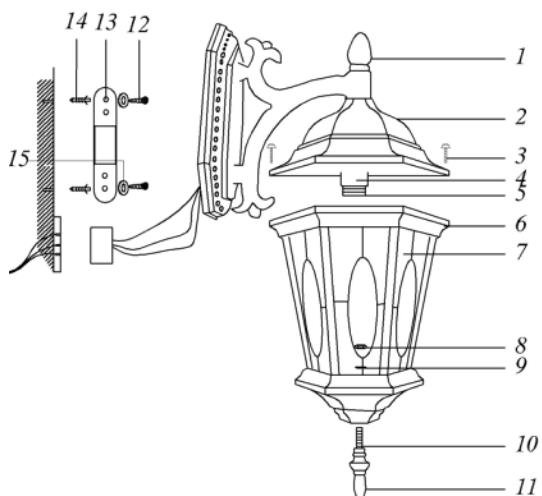
1 – основание; 2 – крышка; 3 – винты крепежные; 4 – ламподержатель; 5 – патрон; 6 – каркас; 7 – стеклянный рассеиватель; 8 – гайка; 9 – гровер; 10 – полое винтовое крепление; 11 – балансина;;
