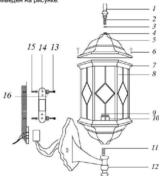
1 – балясина; 2 – полое винтовое крепление; 3 – гровер; 4 –гайка; 5 – винты;
