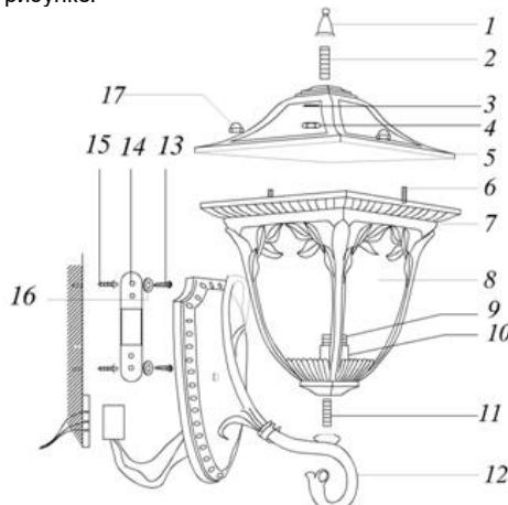
1 – балюсина; 2 – полое винтовое крепление; 3 – гровер; 4 – гайка; 5 – крышка; 6 – винты; 7 – каркас; 8 – стеклянный рассеиватель; 9 – патрон; 10 – ламподержатель; 11 – полое винтовое крепление; 12 – основание; 13 – саморезы; 14 – крепежная скоба; 15 – крепежные отверстия; 16 – шайба; 17 – декоративная гайка.
