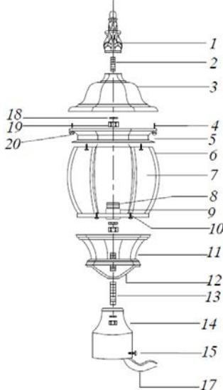
1 – балюсина; 2 – резьбовое крепление; 3 – верхняя крышка; 4 – резьбовое крепление; 5 – верхняя рамка; 6 – каркас; 7 – стеклянный рассеиватель; 8 – патрон; 9 – ламподержатель; 10 – винты; 11 – нижняя рамка; 12 – нижняя крышка; 13 – резьбовое крепление; 14 – постамент; 15 – винт; 17 – провод защитного заземления; 18 – гровер; 19 – гайка; 20 – винт.
